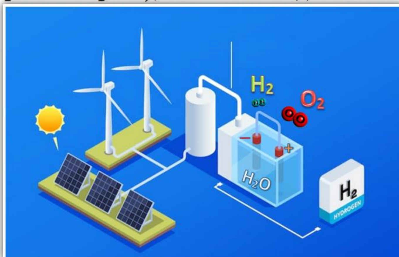
Мал. 19.2. Схема одержання «зеленого» водню електролізом води
